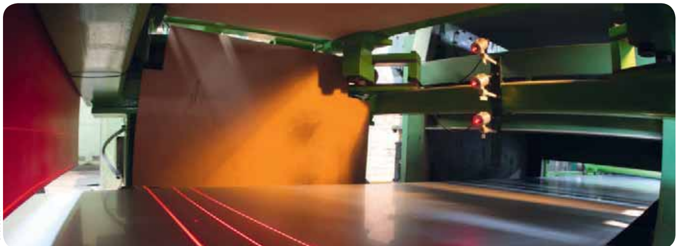
In der Vergangenheit wurde die Produktqualität von kornorientiertem Elektrostahl mit dem menschlichen Auge beurteilt. Da diese Methode jedoch viele Nachteile birgt, entschied sich die tschechische Firma Argutec, ein Oberflächenscansystem zur Qualitätskontrolle einzusetzen – die Basler-ace-Kameras sind nun die Augen des Systems.
