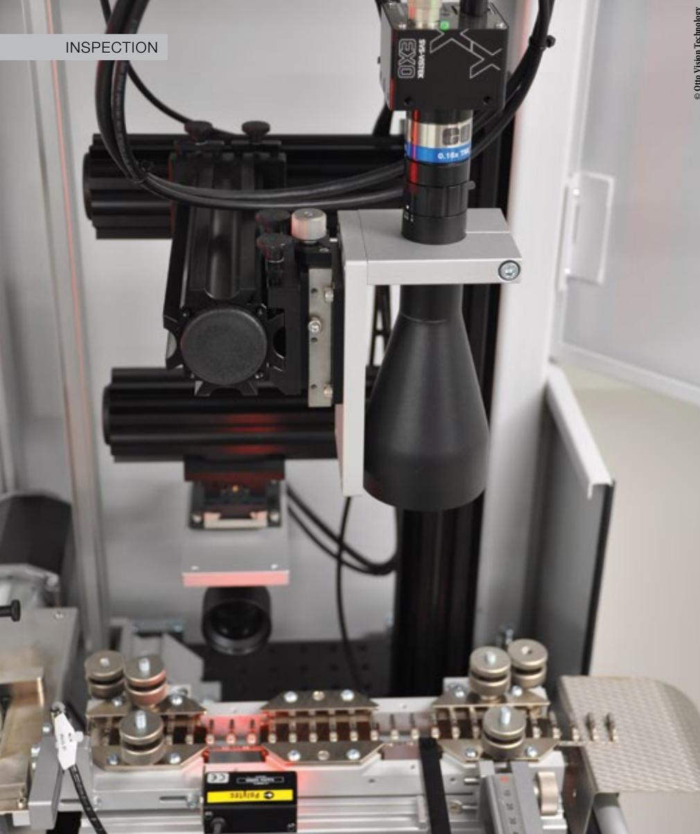
Eine oberhalb des Stanzstrangs montierte EXO-Kamera von SVS-Vistek kontrolliert die Bauteile in Verbindung mit einer telezentrischen Optik von oben, eine weitere nimmt Bilder aus einer um 90 Grad versetzten Position auf.
