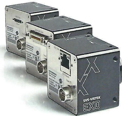
Otto Vision Technology setzt an seinen Prüfstationen Kameramodelle der Exo- und Evo-Reihe von SVS-Vistek mit 3, 5 oder 8 Mpx Auflösung ein. Bild: SVS-Vistek
