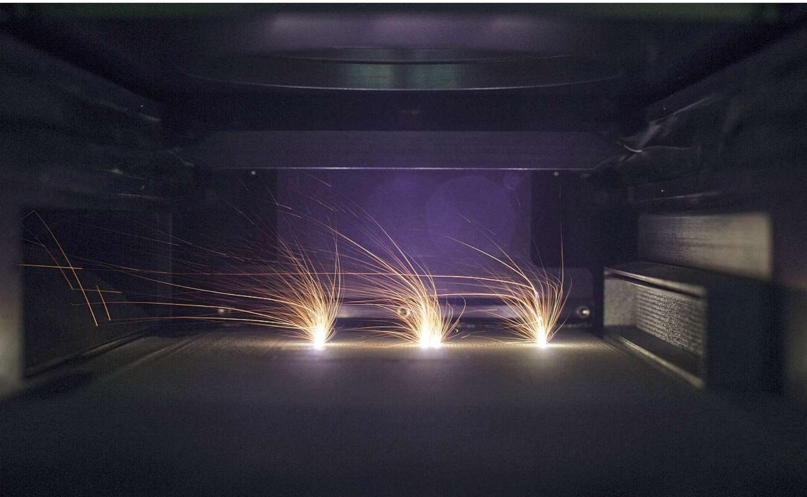
«Die Prozessüberwachung mit Hilfe von Hochgeschwindigkeits-Bildverarbeitungssystemen ist bei PBLM-Prozessen ein wirksames Instrument, um die Qualität von Teilen bereits während der Produktion zu verbessern.»
