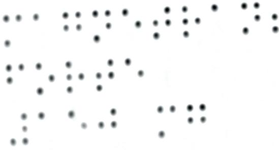
**05** Mit Hilfe des Shape-from-Shading-Verfahrens kann die Höhe der Braille-Punkte mit einer Genauigkeit von  $\pm 0,02$  mm erkannt werden.
