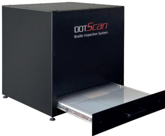
**02** DotScan“-Anlagen sind dafür ausgelegt, die Brailleschrift auf leeren, ungefalteten Faltschachteln Offline im Produktionsablauf zu überprüfen.
