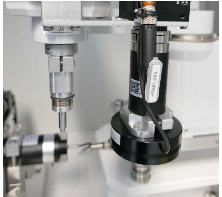
Ein Bildverarbeitungssystem am Arm des SCARA-Roboters garantiert die korrekte Aufnahme der Pipettenspitzen aus den Trays © HEKUMA
