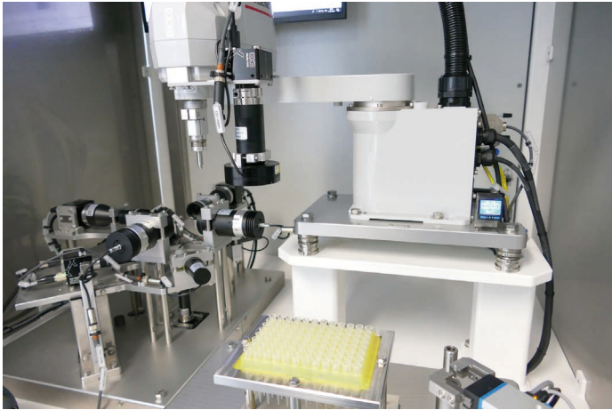
Innerhalb der Prüfstation erfolgt das Handling der einzelnen Pipettenspitzen durch einen SCARA-Roboter © HEKUMA
